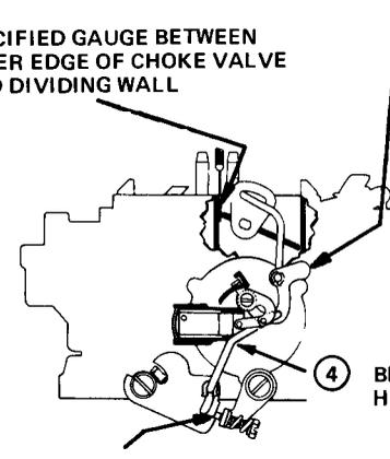
② MOVE INTERMEDIATE LEVER TO FULL UP POSITION TO TAKE UP LASH IN SLOTS
