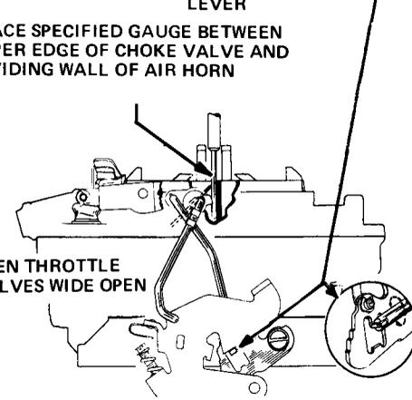
③ BEND TANG ON FAST IDLE CAM TO ADJUST. NOTE: ON SOME MODELS, BEND UNLOADER TANG ON PUMP LEVER
